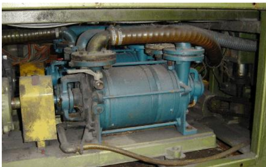
Abb.3: 2-stufige Vakuumpumpen für die Kunststoffprofilkalibrierung
